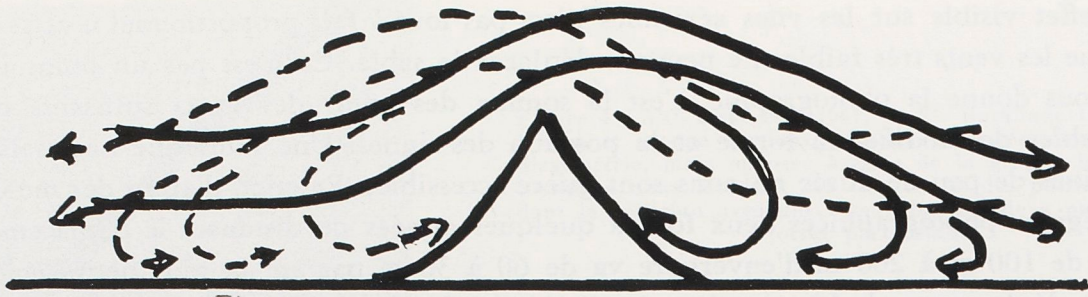
Figure 7 : Profil de ride et circulation de l'air.
