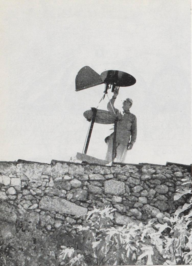
Le capteur installé en Crète permet de calculer le nombre de spores aéroportées.
