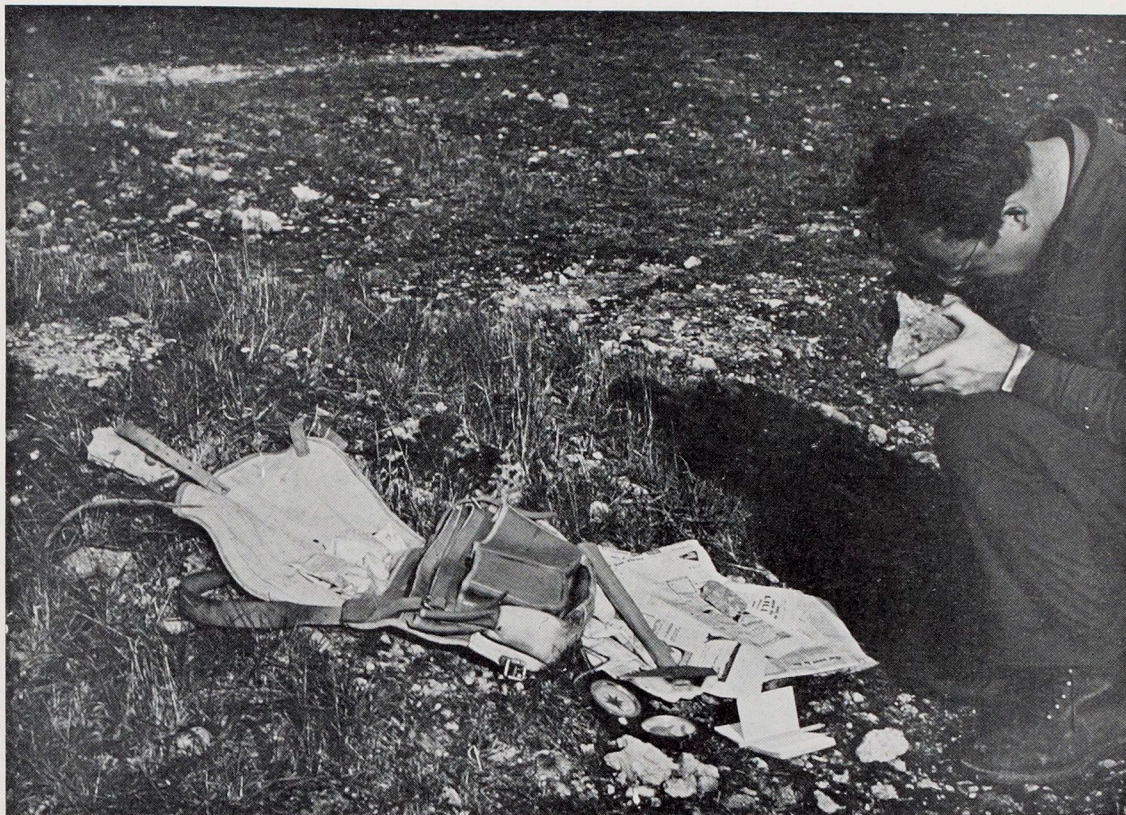
De gauche à droite : la gibecière munie de compartiments, on voit sur le rabat des échantillons enveloppés de papier journal, un clinomètre-boussole et en arrière un marteau de géologue posé sur des journaux, un carnet de note, un crayon. Le chercheur regarde à la loupe un échantillon de roche. On remarquera ses fortes chaussures.
